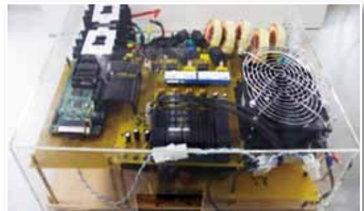
圖3 高性能直流/交流變流器商品化雛形 (側視圖)
