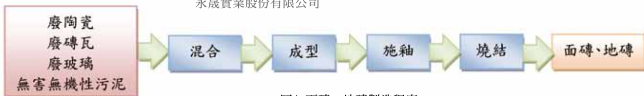
圖4 面磚、地磚製造程序
