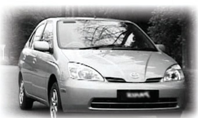
效應一直延伸到車底，另外還在四個車輪的前方加上阻風板，搭配特殊設計的平整化底盤，有助於控制車底空氣流動的效果，進而創造出僅有0.26的超低風阻係數。
