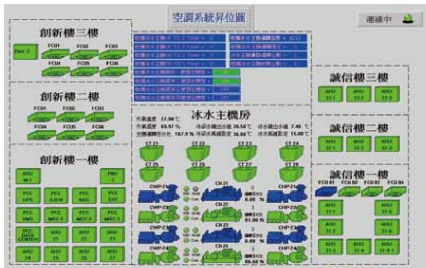
圖8 能源資訊監視系統中之空調系統監控畫面
