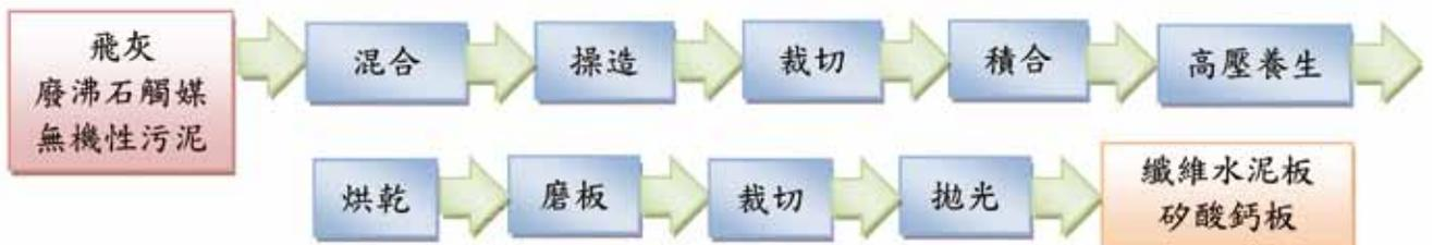
圖6 矽酸鈣板及纖維水泥板製造程序
