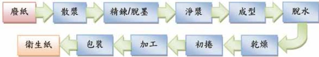
圖1 衛生紙製造程序
