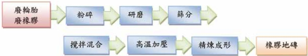
圖3 橡膠地磚製造程序
