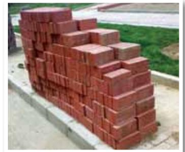
原料經由篩分、碾碎、攪拌、製胚、疊胚、陰乾、乾燥及燒成等程序，以產製紅磚，特性為具耐酸鹼、抗腐蝕、抗壓强度高、耐熱、不變形等特性，用途為提供建築房屋用。
