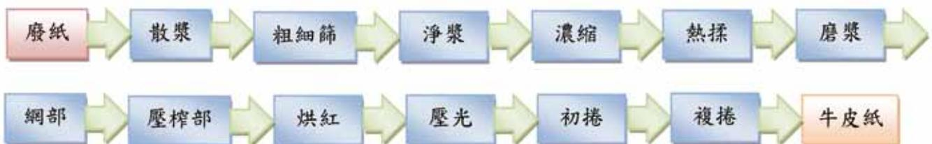
圖2 牛皮紙製造程序
